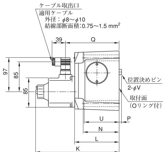
★ 手動調整は、M4ねじ部にM4×20L程度のねじ類をねじ込むか、または、ロッド等を押し込むことにより可能です。
