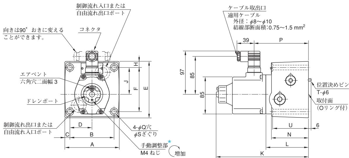
★ 手動調整は、M4ねじ部にM4×20L程度のねじ類をねじ込むか、または、ロッド等を押し込むことにより可能です。
