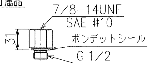
"DR"用アダプタ 二面幅 30 締付トルク: 75~83N・m
